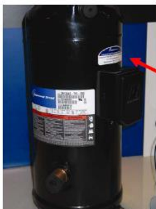
Рис 14: Прогрессивная тепловая защита спирального компрессора (ASTP)
